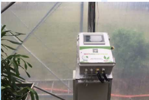
Hệ thống thu thập dữ liệu và điều khiển vi khí hậu nhà màng
